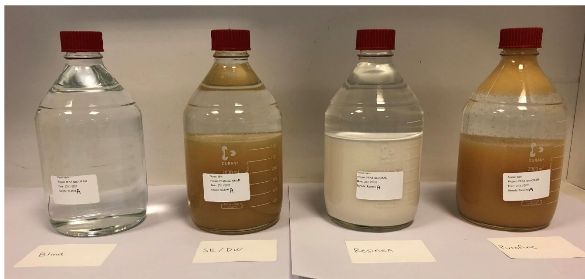
Figur 7: Migrationstest for undersøgelse af afsmittning fra ionbytter resiner udført som batchforsøg. Fra venstre mod højre: Kontrol, SE/DW resin, Resinex PFCR-1, Purofine PFA694E.
