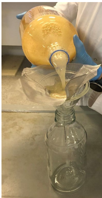
Figur 8: Prøveudtagning til glasflaske gennem metalnet i glastragt for tilbageholdelse af resin.
