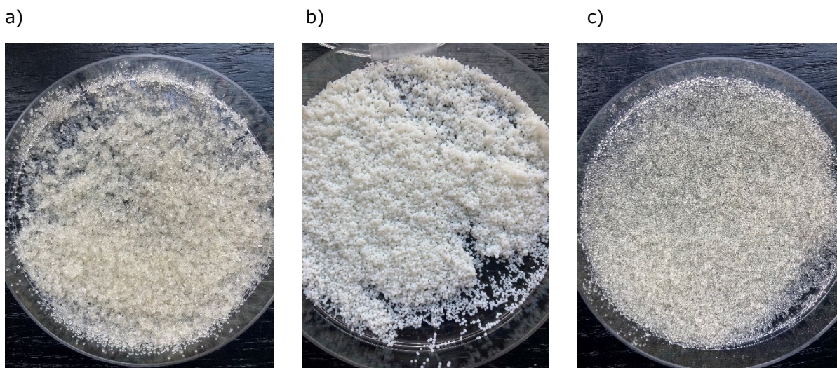
Figur 5: Udseende og struktur på resiner direkte fra original indpakning (ingen behandling). a) Purofine PFA694E resin, b) Resinex PFCR-1 resin, c) fortroligt resin navngivet SE/DW. Forbehandling af resiner
