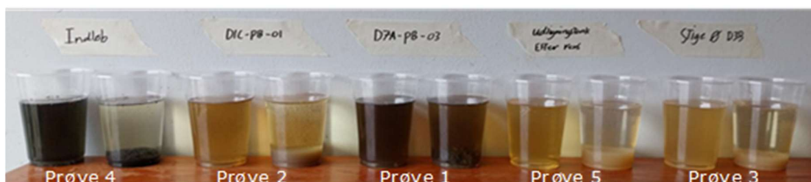
Figur 15 – Viser perkolatprøverne før og efter fældning med FluorFlok
