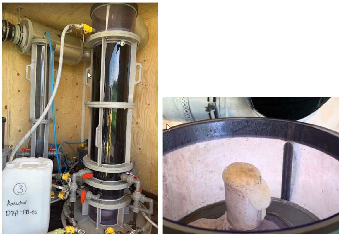
Figur 8 - Påfyldning af skumfraktioneringstank med perkolatprøve og ophobning af skum i "SAFF-keglen"
