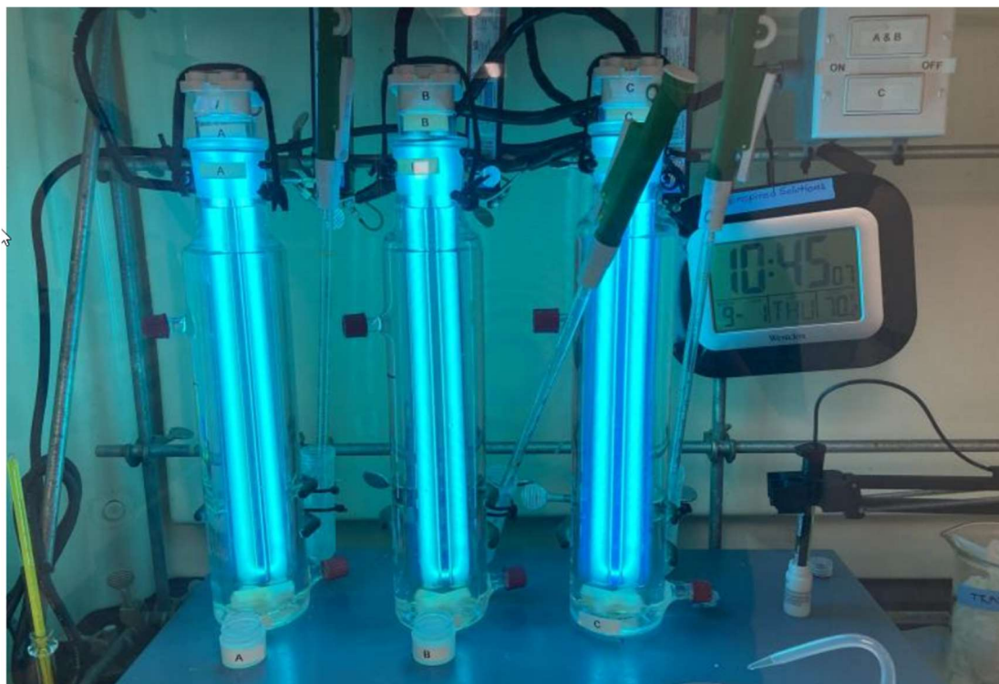
Figur 12 - Labskala forsøg med stationær PRD-reaktor
