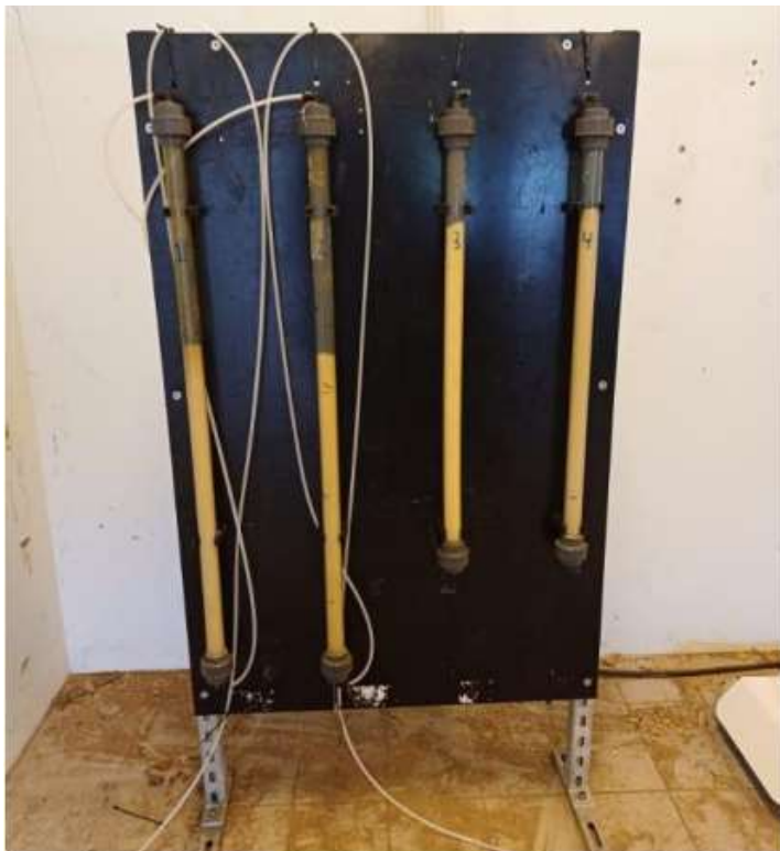
Figur 18 – Resinkolonnerne hvor kolonne nr. 1 og 2 (de to til venstre) er anvendt i pilotforsøget
