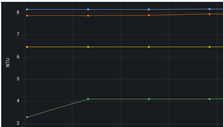
Figur 17 Turbiditet tidsserie for hanevand - fire sensorer i første udgave af udstyr til måling af skyllevands bundfældningshastighed.
