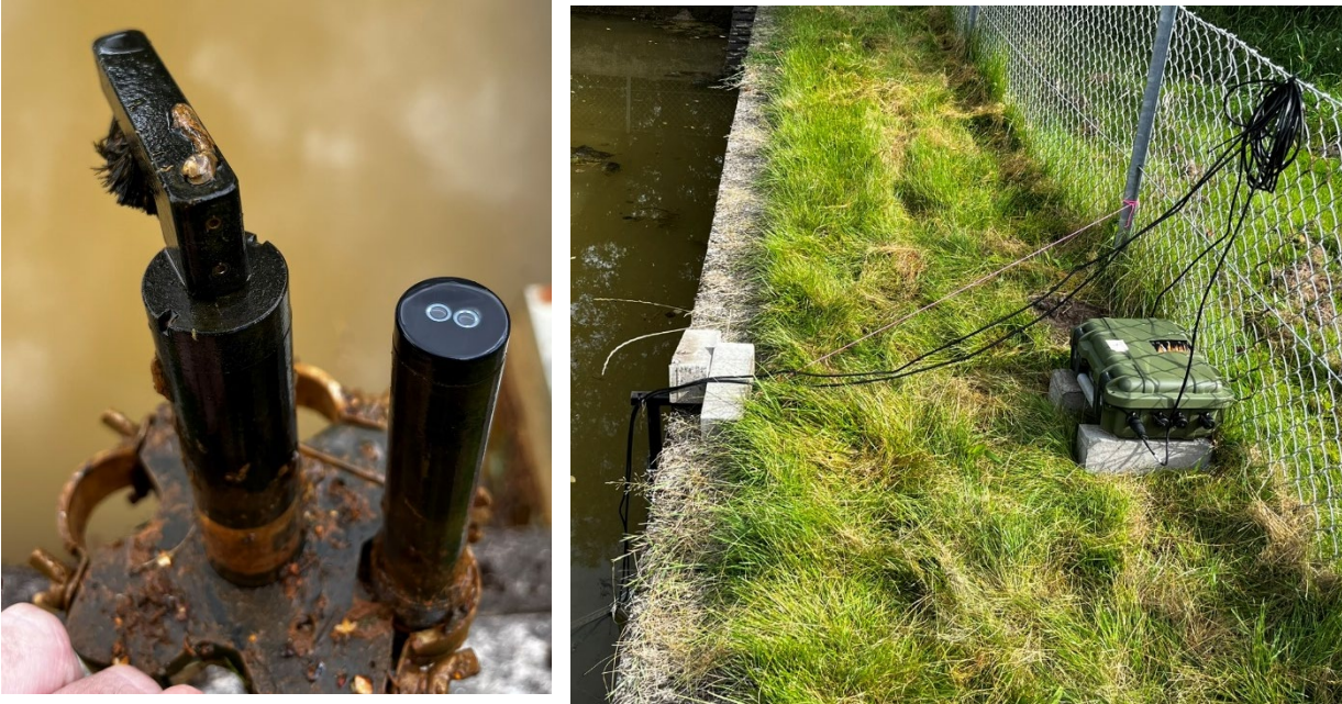
Figur 11 Venstre: Billede af turbiditetssensor og rensbørste. Højre: kufferten med elektronik og batterier.
