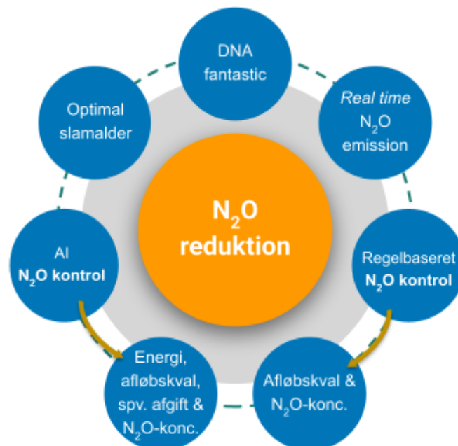
Figur 3: Elementer i en samlet og helstøbt softwareløsning til reduktion af N 2 O emission fra renseanlæg.
