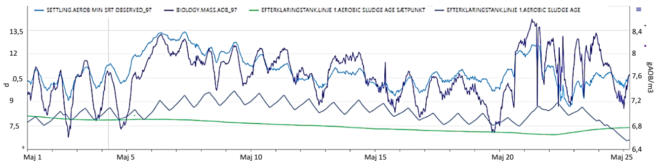
Figur 10: Eksempel på slamalder som funktion af mængden af AOB'er (Nitrosomons) på Aalborg Øst renseanlæg i 2025. Grafen viser, at den AOB-baserede minimum slamalder følger variationer i AOB-indhold og SS-koncentration tæt og giver et mere procesnært styringsgrundlag end traditionelle, statiske slamalderkriterier. Figuren illustrerer følgende tidsserier: BIOLOGY.MASS.AOB – AOB-biomasse i processen, SETTling.AEROB MIN SRT OBSERVED – beregnet minimum slamalder baseret på AOB, EFTERKLARINGSTANK.LINE 1.AEROB SLUDGE AGE – faktisk slamalder, EFTERKLARINGSTANK.LINE 1.AEROB SLUDGE AGE SÆTPUNKT – traditionelt sætpunkt.
