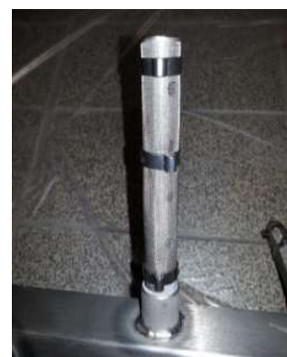
Figur 2 Slangepumpe tilkoblet juletræet (øverst t.v.), juletræet klar til nedsætning (øverst t.h.), nederste del af juletræet med grenenes placering (nederst t.v.), en enkelt gren med filter (nederst t.h.).
