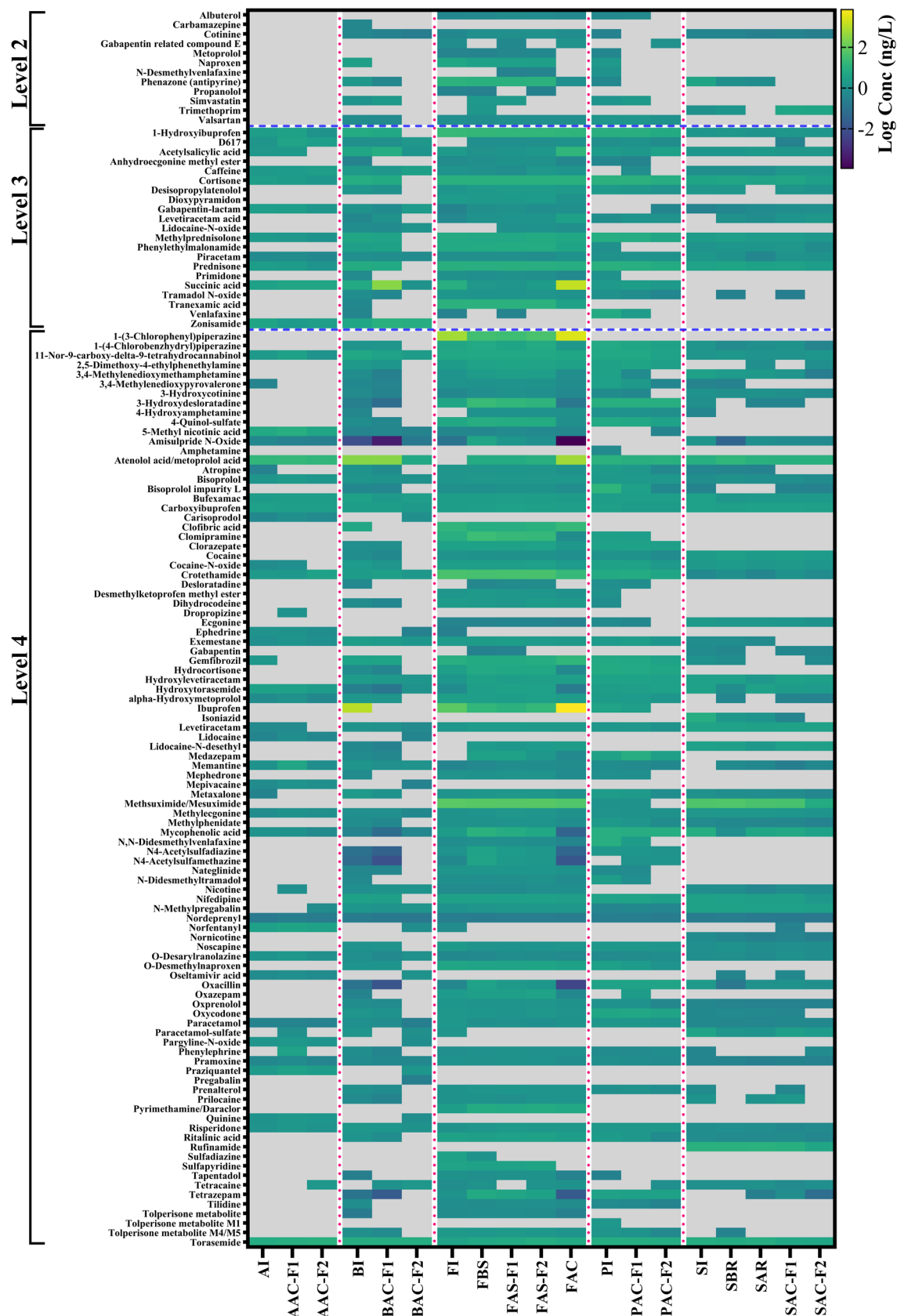
Figur 4.3. Heatmap af 129 medicinrestkoncentrationer hen over behandlingstrin i de fem vandbehandlingsanlæg. I, indløb; AC, aktivt kul; BS, før luftstrippere; AS, efter luftstripper; BR, før resin; AR, efter resin (jf. Figur 4.1). NB: Nogle behandlingstrin er parallelle jf. Fig. 4.1.
